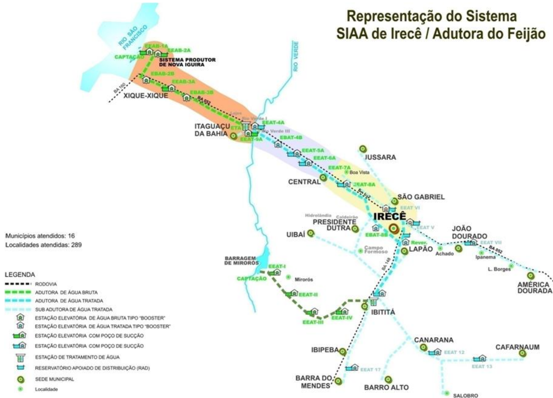
Figura 4-6 – Representação do Sistema Integrado Adutora de Irecê
